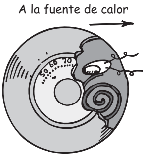
FIGURA 15.16 Un termostato. Cuando una espiral bimetalica se dilata, la gota de mercurio líquido rueda y se aleja de los contactos eléctricos e interrumpe el circuito eléctrico. Cuando la espiral se contrae, el mercurio rueda contra los contactos y cierra el circuito.
