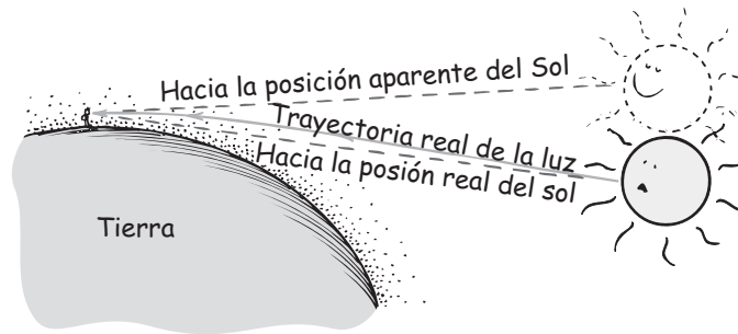
FIGURA 28.19 Debido a la refracción atmosférica, cuando el Sol está cerca del horizonte, parece que está más alto en el cielo.
