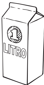
FIGURA 13.12 Un litro de agua ocupa un volumen de 1,000 \text{ cm}^3 , tiene una masa de 1 kg y pesa 9.8 N. En consecuencia, su densidad se expresa como 1 kg/L y su densidad de peso como 9.8 N/L. (El agua de mar es un poco más densa, más o menos 10.0 N/L.)
