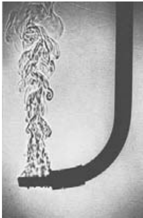
FIGURA 16.5 Un calentador en la punta del tubo en forma de J sumergido en agua produce corrientes de convección, las cuales se ven como sombras (causadas por deflexiones de la luz en el agua a distintas temperaturas).
