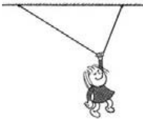
FIGURA 5.25 Nellie Newton cuelga inmóvil, con una mano en la cuerda del tendedero. Si la cuerda está a punto de romperse, ¿de qué lado es más probable que lo haga?
