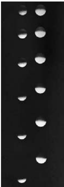
FIGURA 4.16 Fotografía estroboscópica de una pelota de golf (izquierda) y una pelota de poliuretano (derecha) que caen en el aire. La resistencia del aire es despreciable para la pelota más pesada, y su aceleración es aproximadamente igual a g . La resistencia del aire no es despreciable para la pelota ligera de poliuretano, la cual alcanza muy pronto su velocidad terminal.
