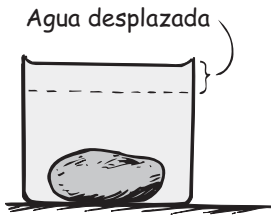
FIGURA 13.11 El aumento del nivel del agua es el mismo que se tendría si, en vez de poner la piedra en el recipiente, hubiéramos vertido en él un volumen de agua igual al volumen de la piedra.
